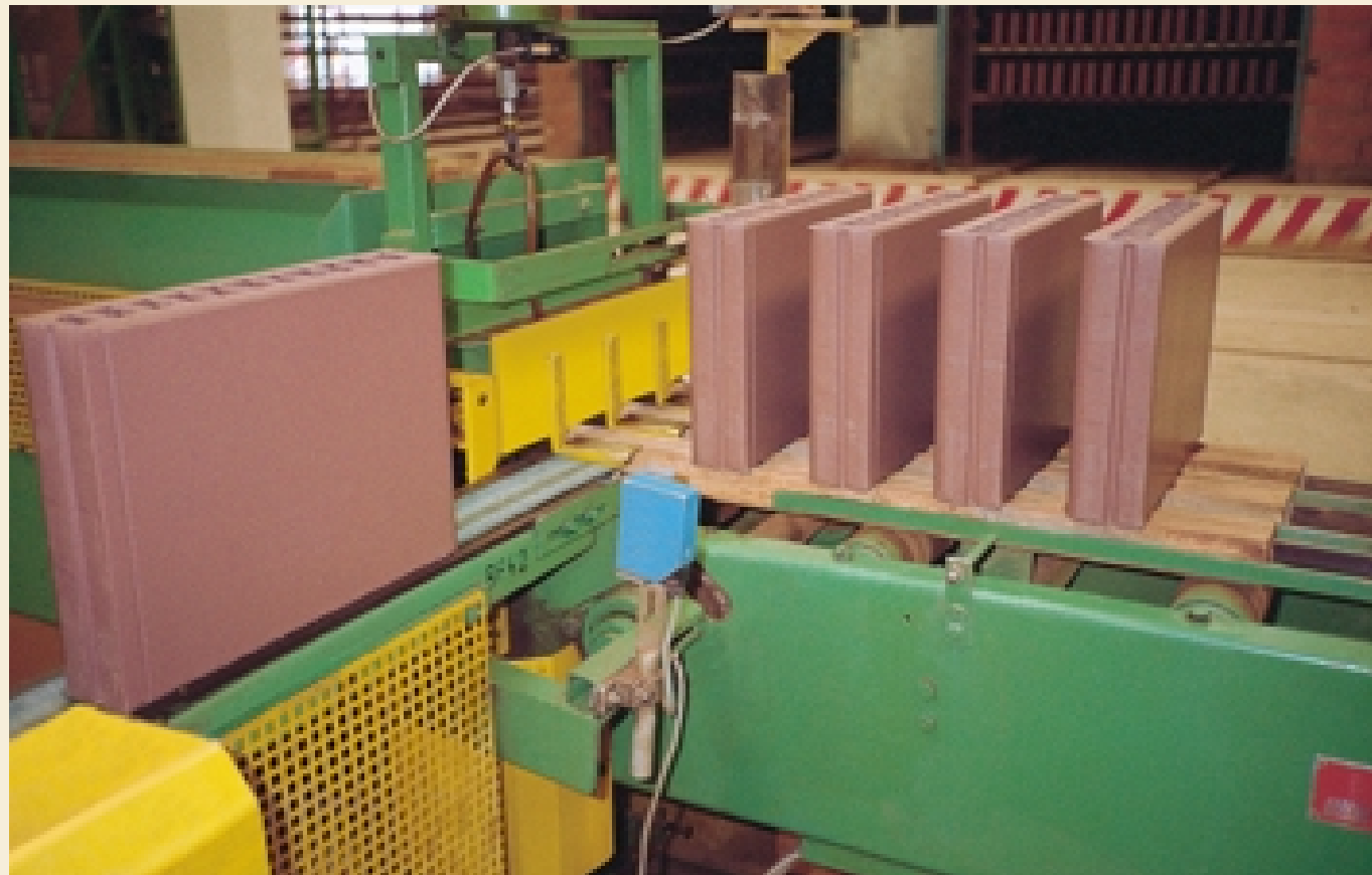
▼ Treppenstufen-Doppelplatten werden auf die Formlingsträger abgesetzt
