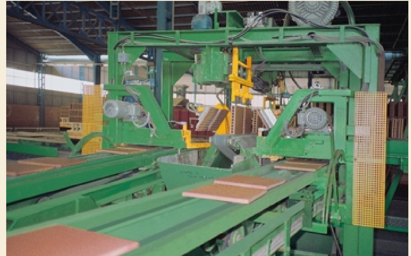
▼ Spaltplatten-Trennanlage für vertikales Trennen und Ablegen mit den Sichtflächen nach oben
