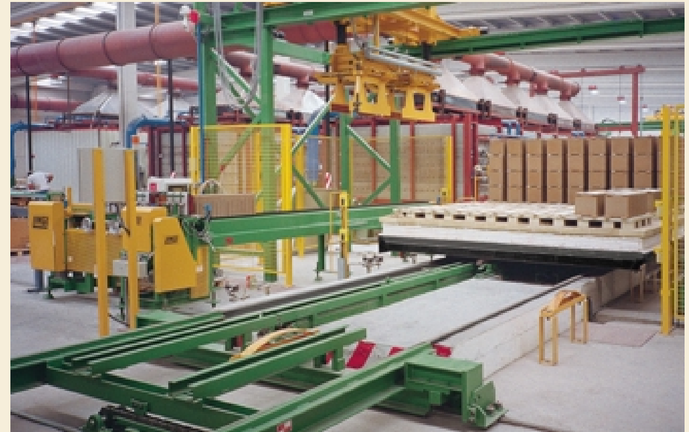
▲ Spaltplatten werden in Reihen vom Ofenwagen entladen, einzeln und der Trennanlage zugeführt
