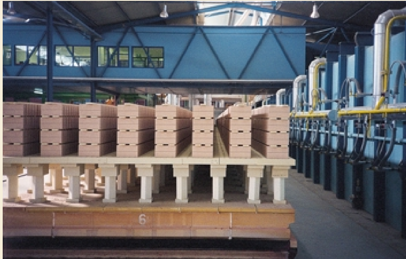
▼ Tunnelofenwagen mit Sockelleisten, Lingl-Tunnelofen mit Seitenbrennanlage
