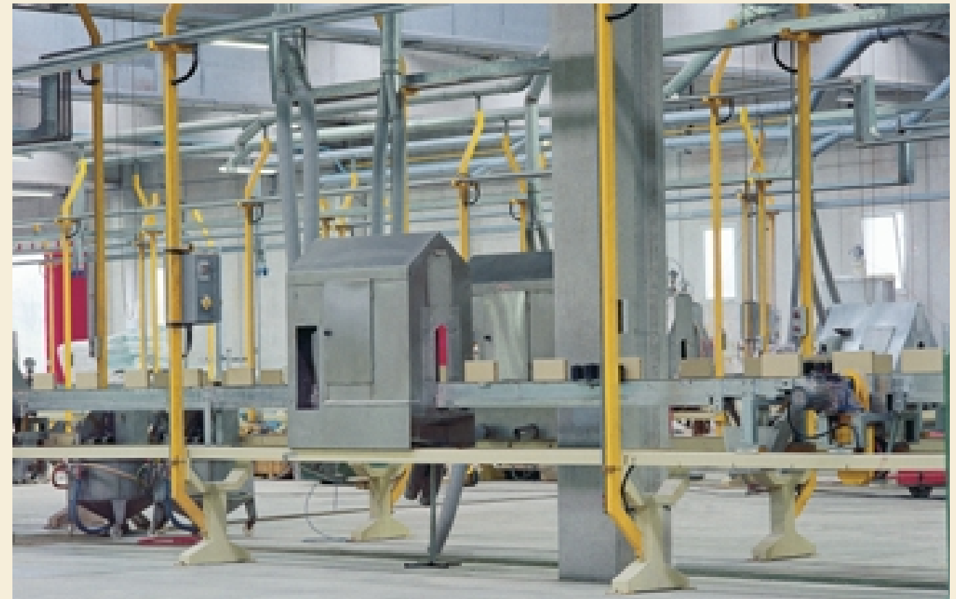
▼ Mehrstufige Glasierstationen für beidseitiges Trockenglasieren mit dem Lingl-Schleuderverfahren für hochwertige Glasuren, auch mit speziellen Farbeffekten und unterschiedlichen Deckschichten. In Kombination mit Druckluft- Spritzsystemen und Spezialantrieben können besondere Schattierungseffekte erzeugt und auch die anspruchsvollsten Glasuranforderungen gelöst werden.
