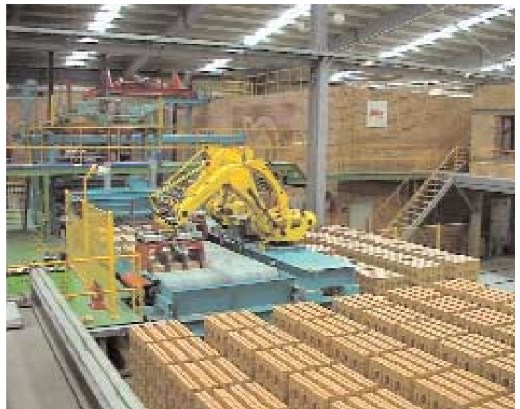
Bild 1: Blick auf die Setzroboter und den Durchlauf Trockner Fig. 1: View of the setting robots and the continuous dryer
