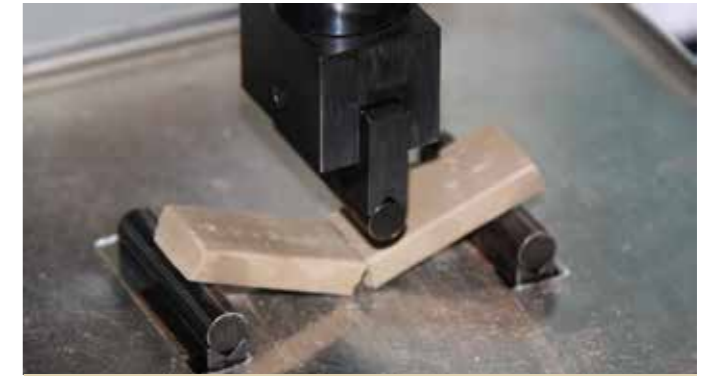
Лабораторный анализ: проверка прочности на изгиб Laboranalyse: Prüfung der Biegefestigkeit
