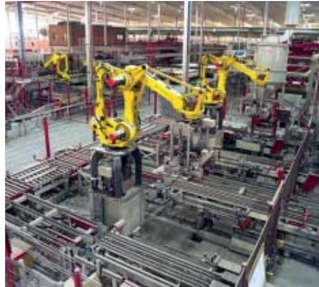
Bild 4: Roboter-Verpackungslinie mit vier Wachs-Sprühenden Stationen Fig. 4: View on the split paver packaging line with four wax spraying booths
