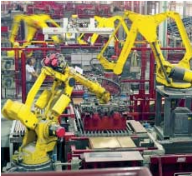
Bild 3: Roboter-Entladung über separate Roboter-Verpackungslinien Fig. 3: Robot unloading via separate robot packaging lines
