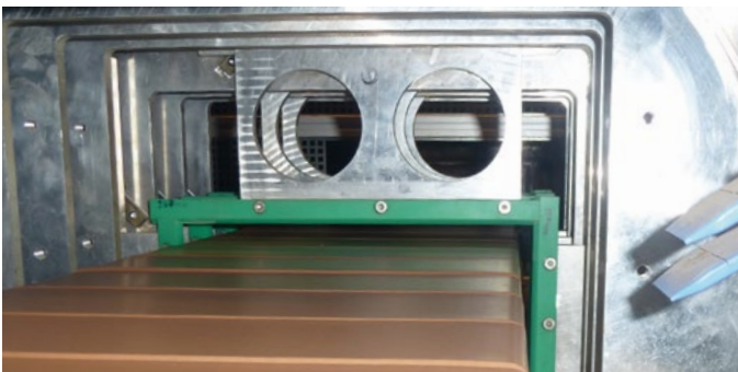
Плавнастраиваемое устройство для снятия фаски в резчике ротационного действия Continuously adjustable chamfering device in the rotary cutter
