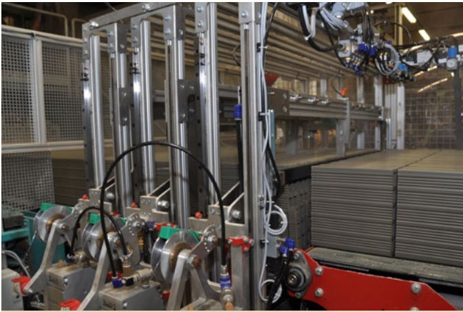
Резчик для многоручьевого выхода бруса с обрезным резом Cutter for multiple column extrusion with waste end cutting
