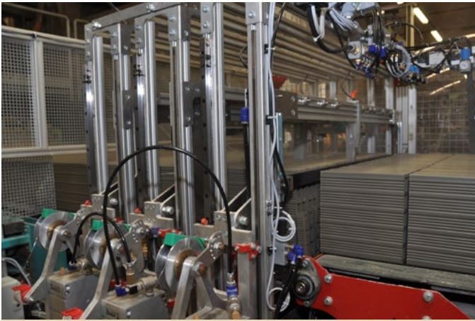
Abschneider für Mehrfachstrangaustritt mit Abfallschnitt Cutter for multiple column extrusion with waste end cutting
