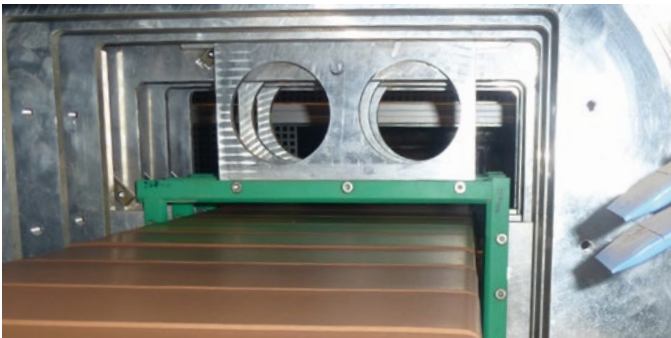
Stufenlos einstellbare Anfasseinrichtung im Rotationsabschneider Continuously adjustable chamfering device in the rotary cutter
