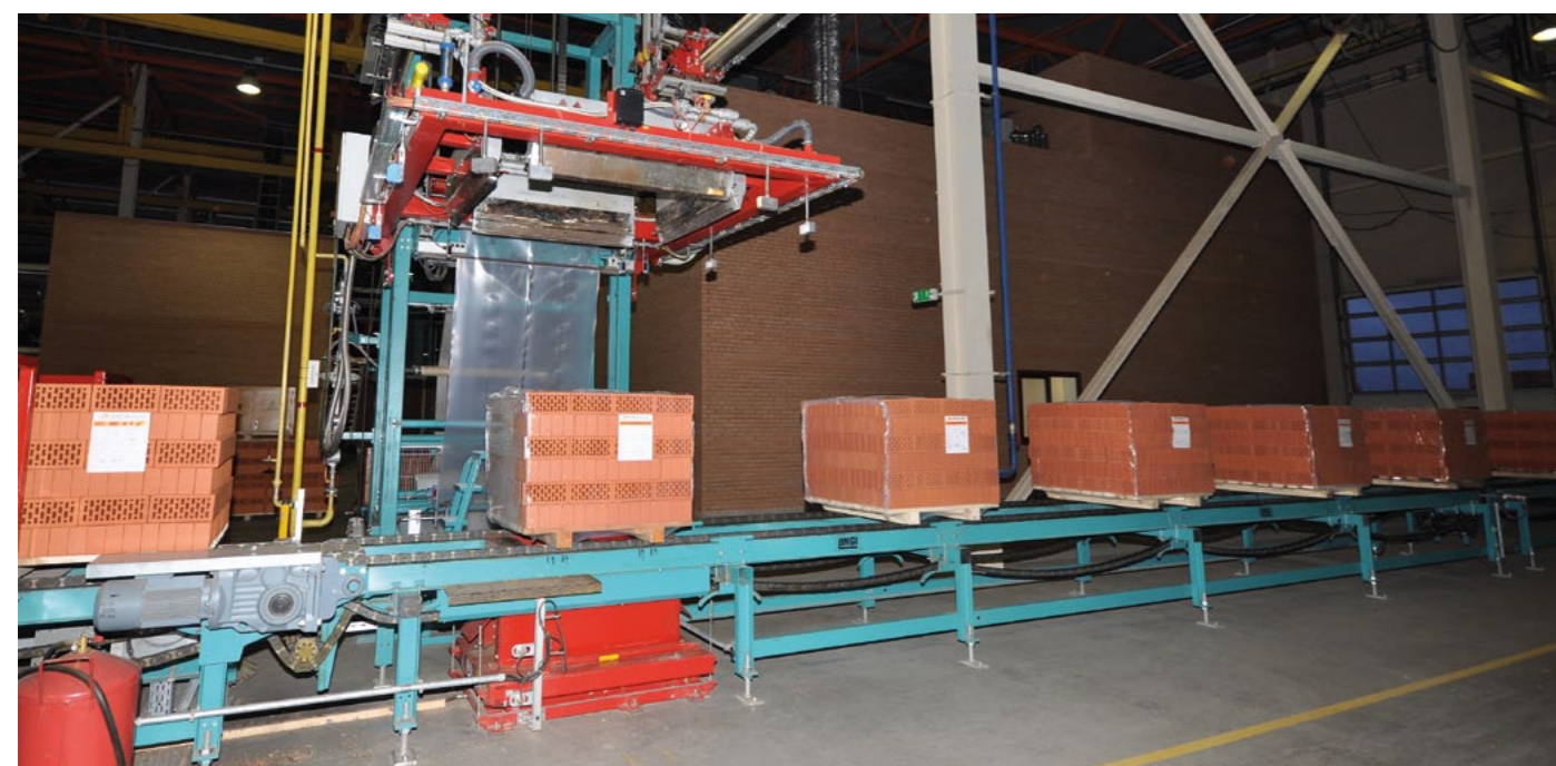
LINGL Kombipack Equipment with Shrink Foil автомат Комбипак фирмы ЛИНГЛ для надевания и усадки пленки
