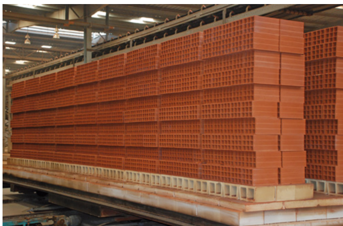
Produits cuits sur wagon de four tunnel Fired products on tunnel kiln car
