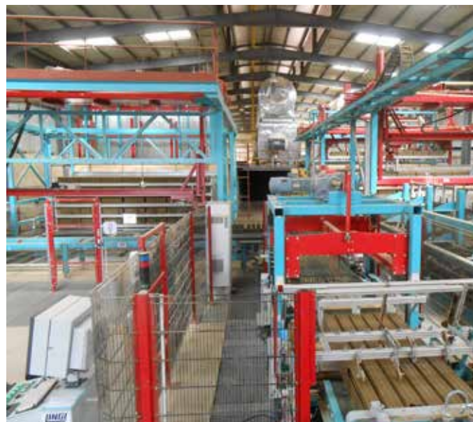
Circuit des produits verts avec chargement et déchargement du séchoir Wet side with dryer loading and unloading
