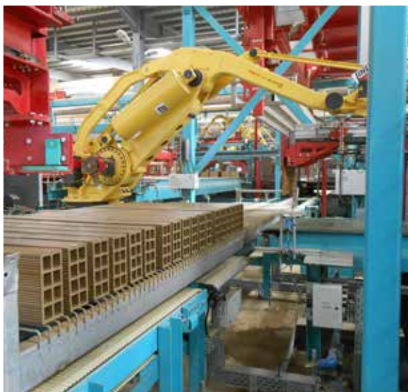
Briques sur la claie Bricks on drying support
