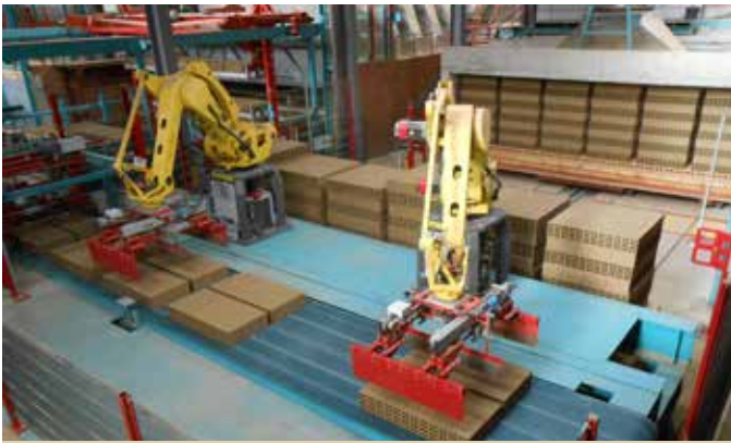
Robot d'empilage et pré-four Setting robot and preheater
